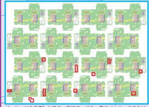
パッケージを検査した時の一例です。ゴミ、傷やバーコードの欠け などを、自動検査します。
